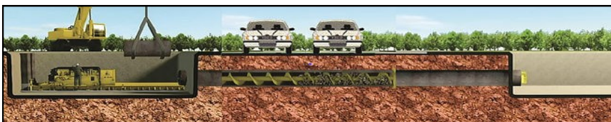
Instalación camisa de 36" sistema Auger Boring. ISA Transelca Barranquilla
